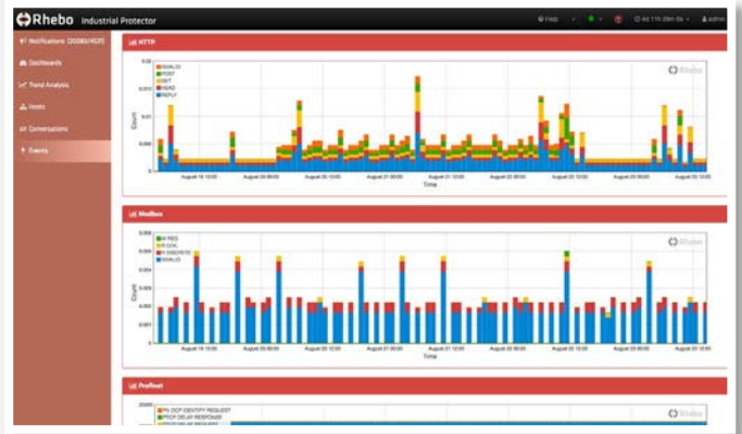
Verteilung von HTTP- und Modbus-Kommunikation über die Zeit
